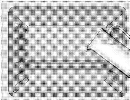
3. Réglez le four en mode de nettoyage facile à la vapeur et faites-le fonctionner à 100 °C pendant 15 minutes.
