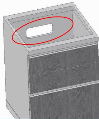
2) Insérer le raccord télescopique à l'arrière du produit
