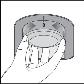
La température de fonctionnement est réglée à l'aide de la commande de température.
